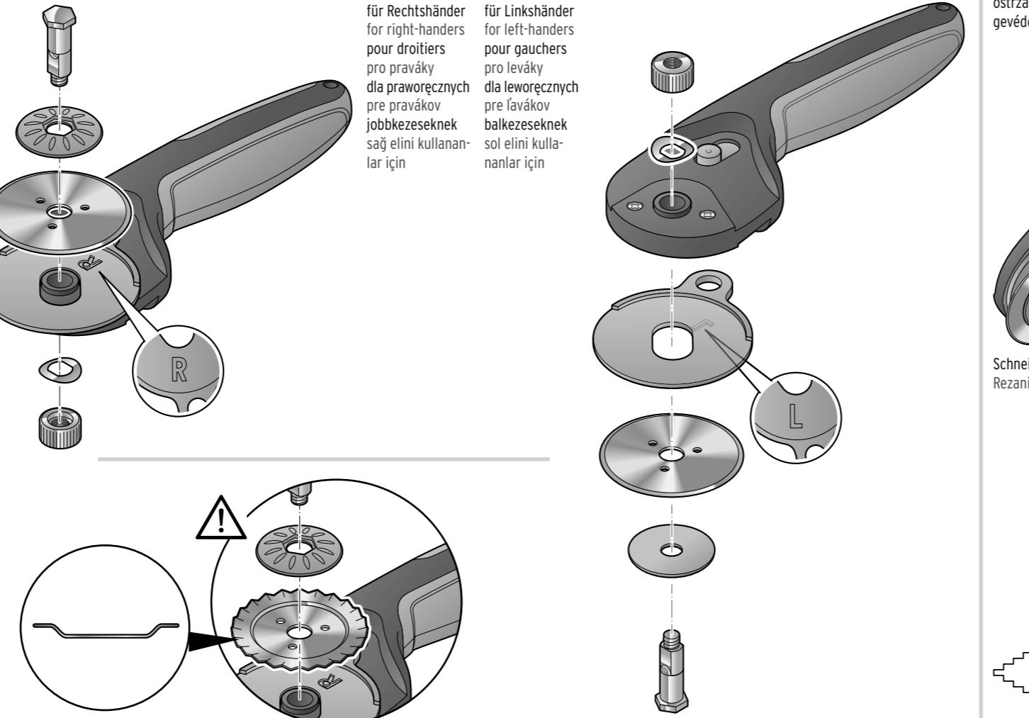
Klingenschutz zurückziehen | Disabling the blade protection | Rétracter le protège-lame | Stažení ochrany čepele směrem dozadu | Przesuwanie ostrza do tyłu | Posunutie ochrany čepele vzad | Pengevédő visszahúzása | Biçak korumasını geri çekmek
